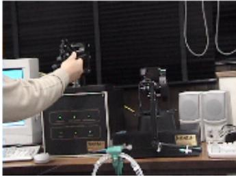
Fig 14 PHANTOM を組み合わせたガイドワイヤー遠隔操作装置
