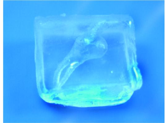
RP 装置を用いた脳血管モデル
