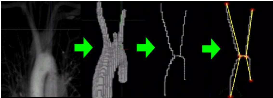
図 3 画像処理による大血管のグラフ化
